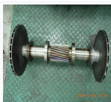
离心压缩机轴径 / 叶轮 / 止推面修复
