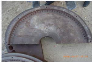
隔板裂纹、掉块修理
