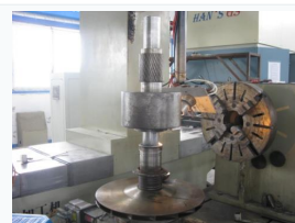
离心压缩机轴径 / 叶轮 / 止推面修复
