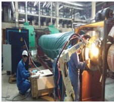
电机转子激光现场熔覆
