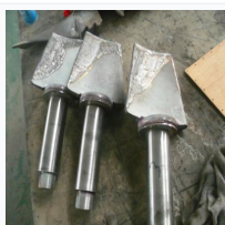
Repaired Adjustable Blades 修复后的可调叶片
