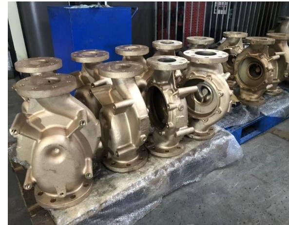
**Направляющие лопатки, впускные фланцы и лопаточные диски из шарового чугуна и алюминиевой бронзы**
